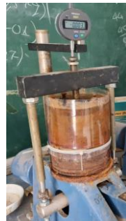
Hình 2.13: Thiết bị có kết cải tiến để xác định ma sát giữa đất và thành dao vòng.
